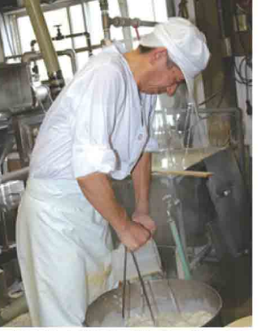
にがりを打つ温度は85~90℃。高い温度で瞬間にして固めるのがポイント
